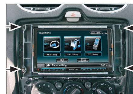
3. Do otvoru pro autorádio umístěte plastový adaptér a zajistěte jej šrouby. Do adaptéry zasuňte kovový rámeček. Připojte konektory do instalované jednotky. Zasuňte instalovaný přístroj do kovového rámečku dokud neuslyšíte cvaknutí bočních zámků.
